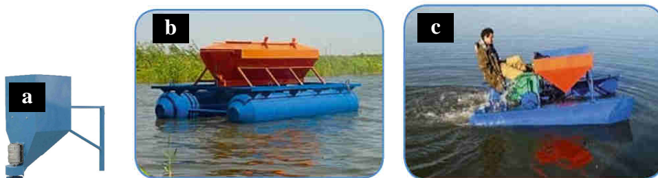
2.2.7 pav. Žuvų šėrimo įrenginiai: a – automatinė šėrykla, b – šėrykla tvenkininė (švytuoklinė), c -pašarų dalytuvas
