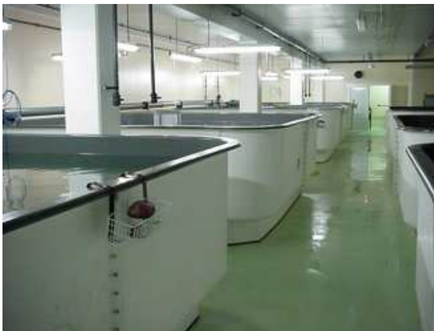
3.1.9 pav. Standartiniai kvadratiniai baseinai su užapvalintais kraštais.
