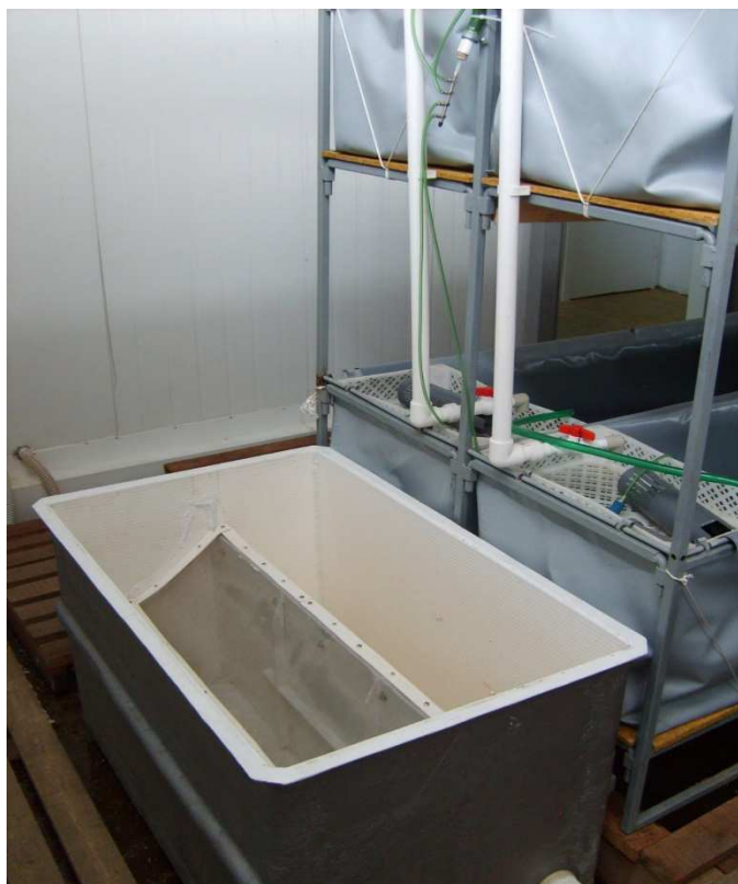
3.4.3 pav. Mechaninis filtras su stabilia tinkline medžiaga
