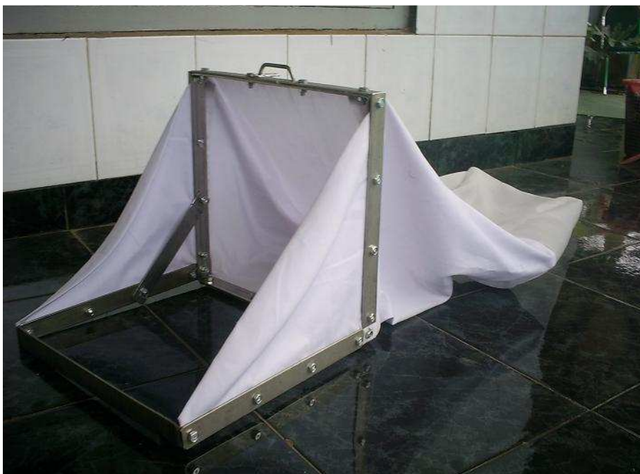
27.4 pav. Upių dugno gyvūnams tirti naudojama rėminė gaudyklė.
