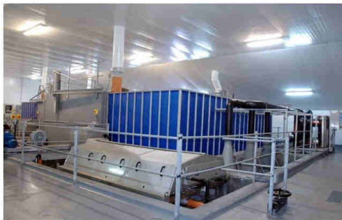
Klasikinės fermos tipo uždarojo apytakos ciklo sistema (RAS)
